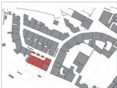
Der Rücksprung der Gebäudeflucht im Norden schafft private Höfe
