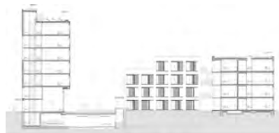
Der Riegelbau dient als Schallschutz für das gesamte Baugebiet.
