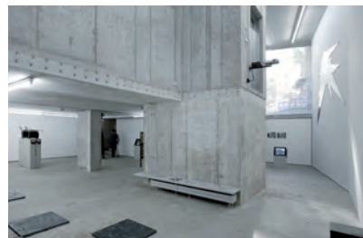
Das Gebäude ist nutzungs- und aneignungsoffen geplant. Die auf Winkeln ruhende Fassade ist einfach austauschbar, so dass sie jederzeit an die Bedürfnisse der dahinter liegenden Nutzungen angepasst werden kann.
