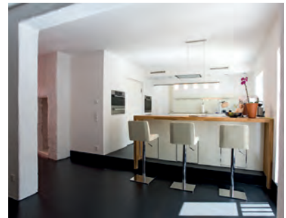
Sämtliche Fenster und Einbaumöbel wurden aus mit Speziallack beschichteten Holzwerkstoffen hergestellt.
