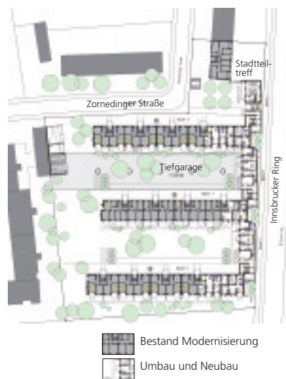
Freiflächenplan und Erdgeschossgrundriss; Die Grundrisse wurden so organisiert, dass die Individual- und Wohnräume zu den leisen Innenhöfen und die „unsensiblen Räume“ zur lauten Seite hin orientiert sind.
