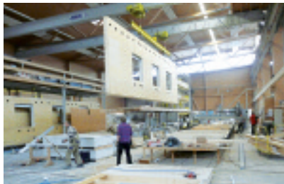
Fertigung der Holzfassadenelemente
